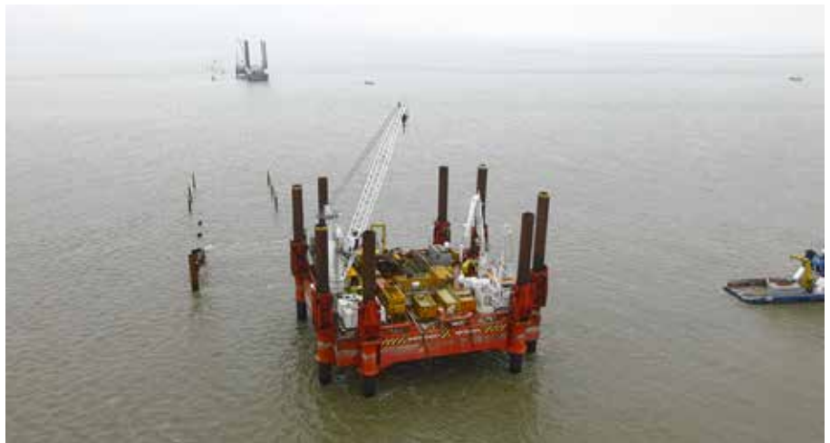
Het hefeiland kan functioneren als werkplatform met vier poten, maar ook als wandelend werkplatform met acht poten.
